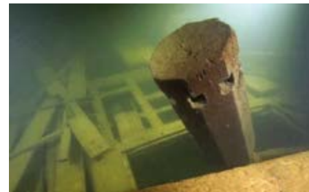
Een kaapstaander van de Huis te Warmelo. Met de kaapstaander werden ankers en andere zware lasten gehesen. In de gaten stak men spaken waartegen de matrozen duwden. (foto SubZone)
